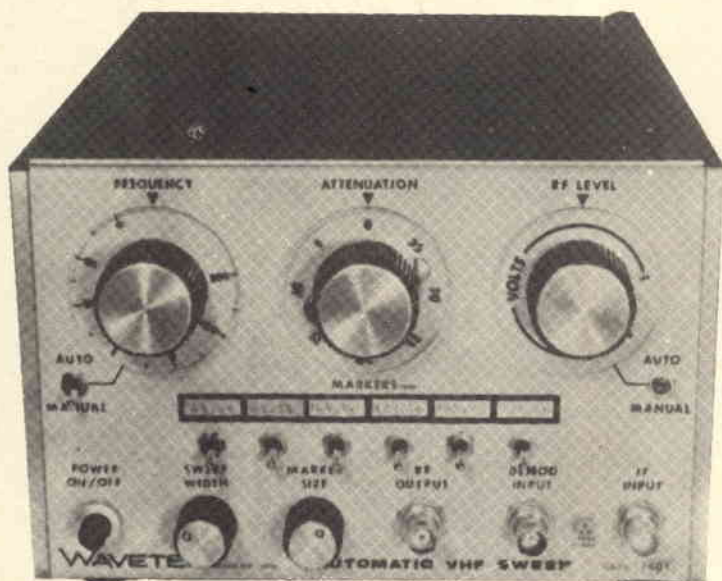
Fig. 10 - Aspetto del volubatore nella sua veste commerciale. Questo strumento è disponibile in diverse versioni.
