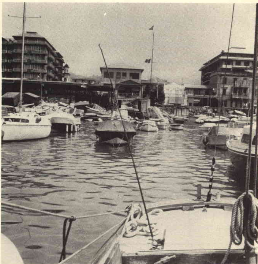
Fig. 7 - Ecco la «frusta nera» montata a poppa di un cabinato per il servizio marino del Canale 1 dei 27 MHz.
