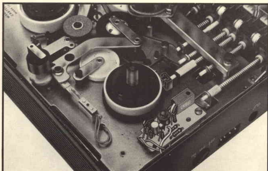
Fig. 3 - Esempio di montaggio dell'UK 690 all'interno di un registratore a bobina.
