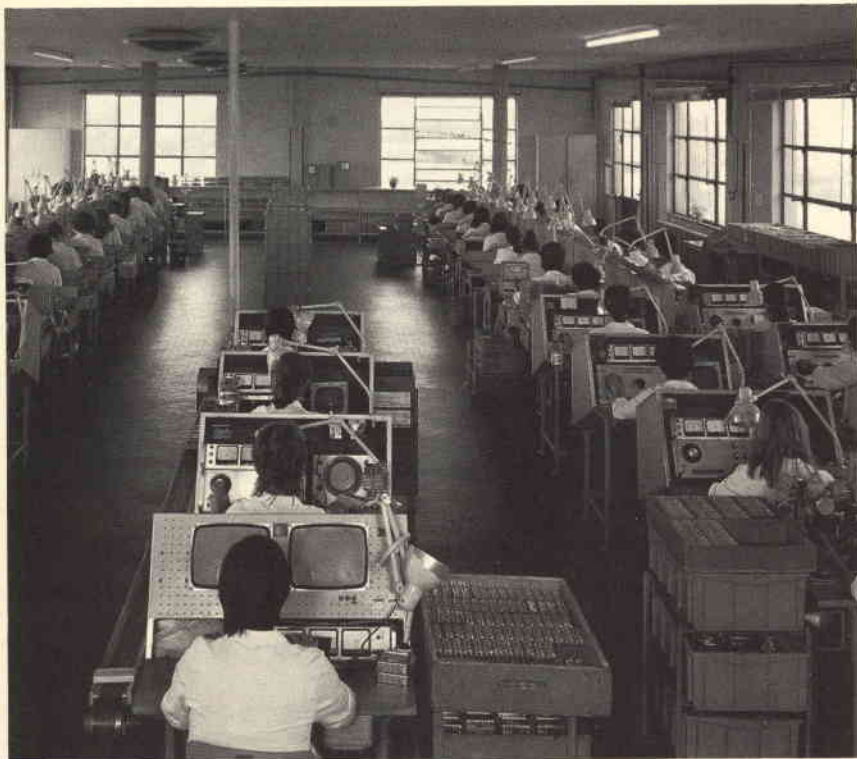
Fig. 2 - Una catena di montaggio, con relativo reparto di controllo, dei sintonizzatori a diodi varicap.
