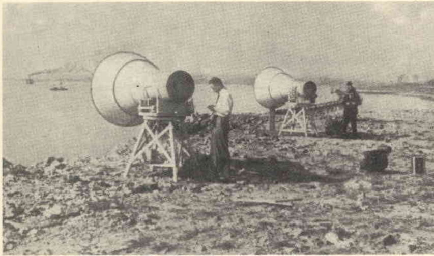
Fig. 17 - Foto illustrante i primi esperimenti compiuti con un radar munito di antenne direttive, nel 1939.
