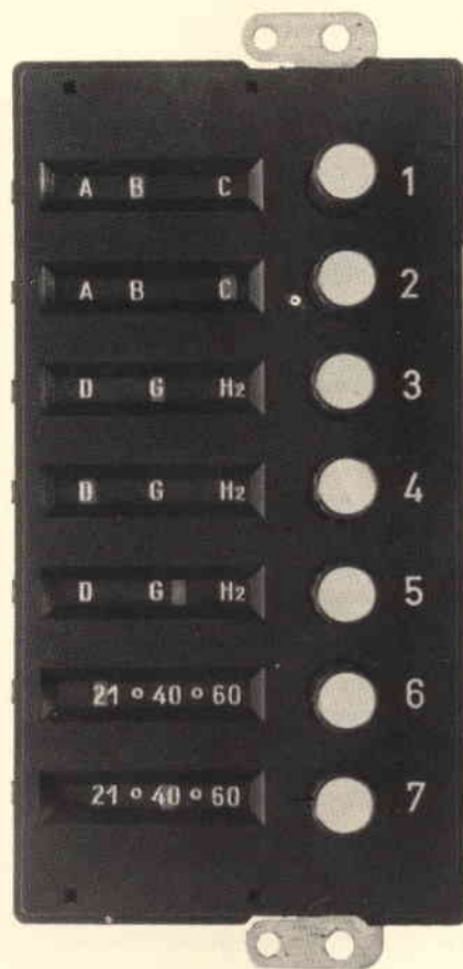
Fig. 6 - Fotografia di una tastiera potenziometrica a 7 pulsanti nelle finestrelle sono visibili i canali predisposti.
