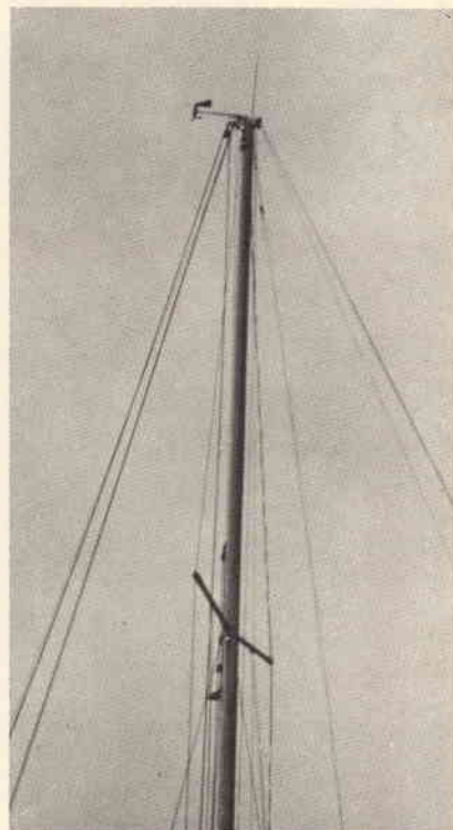
Fig. 8 - Ecco una «frusta nera» montata in testa d'albero di un cabinato, sempre per il servizio marino del canale 1 dei 27 MHz.
